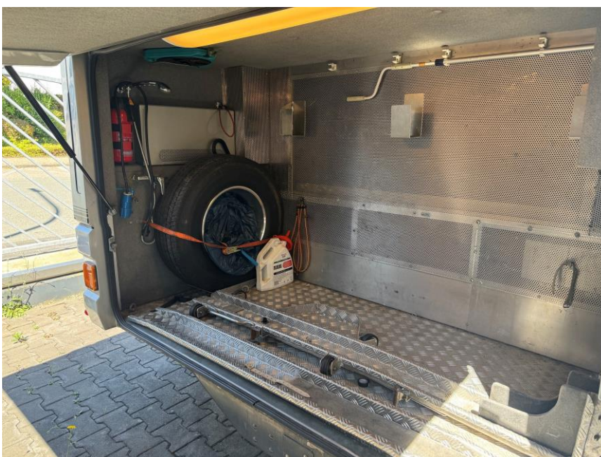
Ersatzrad, Druckluftanschluss und Stauraum
