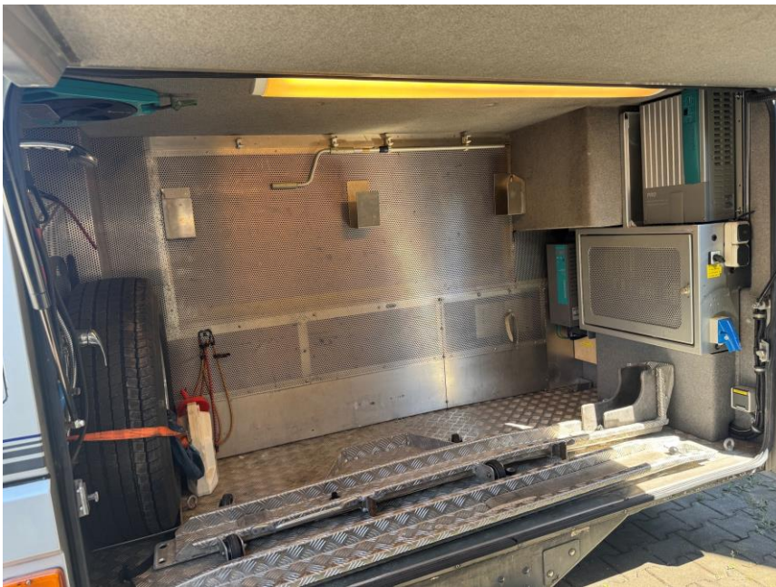
Heckgarage – Innenansicht mit Verladevorrichtung und Beleuchtung
